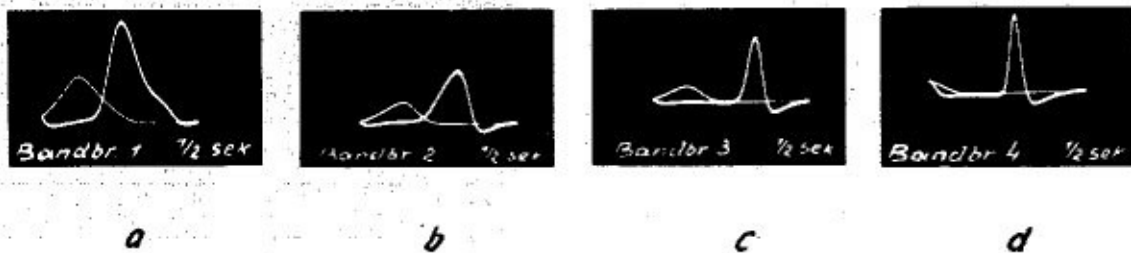
Abb. 10 Selektionskurven des Schwer-Lang-Empfängers bei verschiedener Bandbreite.
