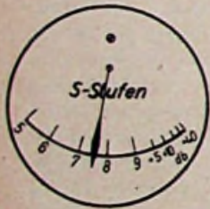
Abb. 1. Schaltbild des UKW-Empfängers „e“, in dem die für den Amateurbetrieb zweckmäßigen Änderungen rot eingezeichnet sind. Abb. 2 (links nebenstehend). Die vorgeschlagene Skaleneinteilung für das S-Meter
