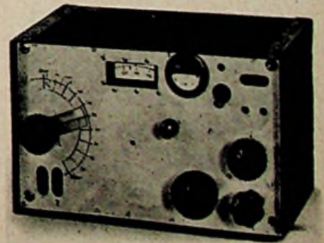
Abb. 6. Vorderansicht des Gerätes. Die beiden Knöpfe rechts außen dienen zur Bedienung des Telegrafieüberlagerers
