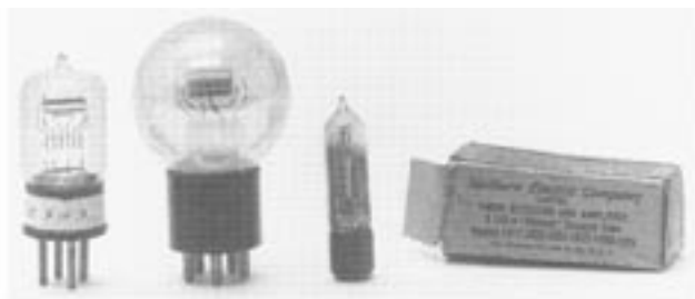
Bild 554 [Sammlung Erb, Luzern] Peanut-Röhre 215A mit Originalschachtel von Northern Electric Company, Kanada und RE71 von Telefunken sowie Telefonröhre als Grössenvergleich.
