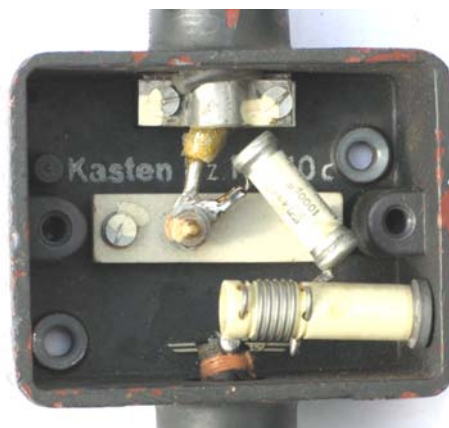
Abb. 16: Antennenzuleitung n; Kasten Pz. Nr. 10c geöffnet
