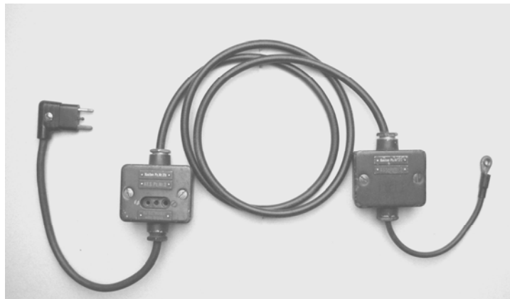
Abb. 1: Ansicht Antennenzuleitung f
