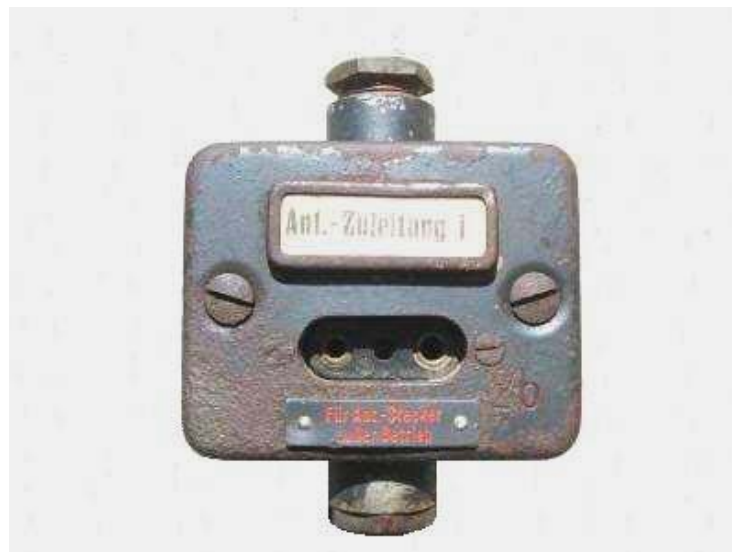
Abb. 9: Antennenzuleitung i; Kasten Pz. Nr. 2b
