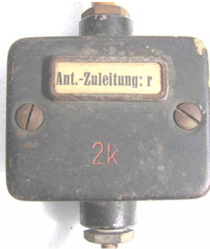
Abb. 22: Antennenzuleitung r; Kasten Pz. Nr. 2k
