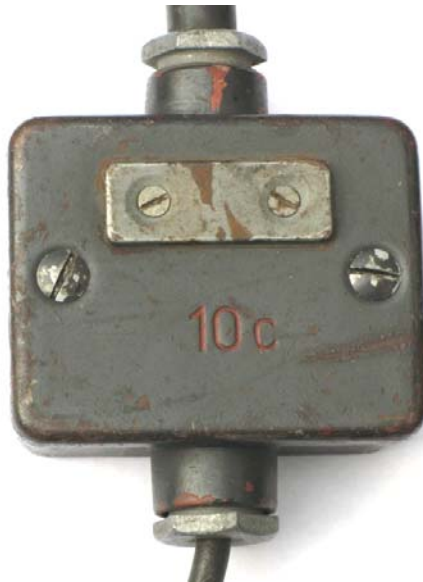
Abb. 15: Antennenzuleitung n; Kasten Pz. Nr. 10c
