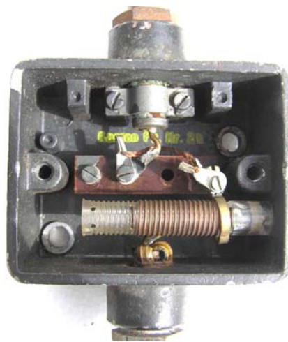
Abb. 23: Antennenzuleitung r; Kasten Pz. Nr. 2k geöffnet
