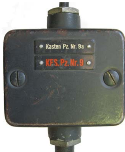
Abb. 10: Antennenzuleitung i; Kasten Pz. Nr. 9a
