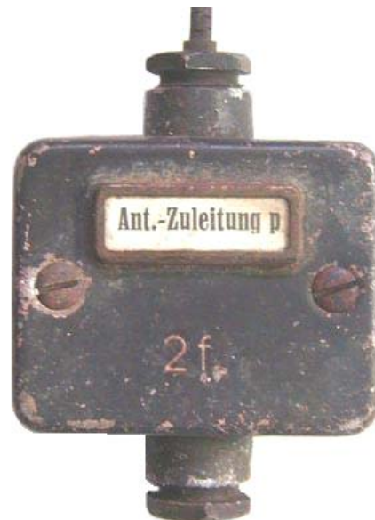
Abb. 19: Antennenzuleitung p; Kasten Pz. Nr. 2f
