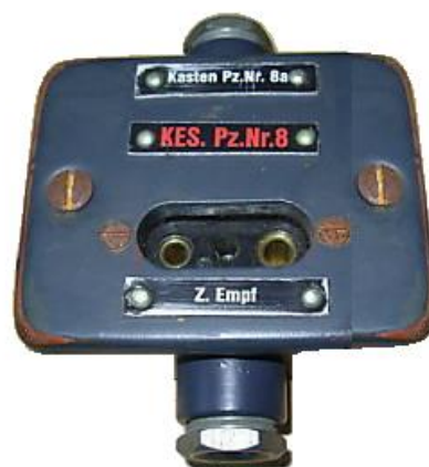
Abb. 7: Antennenzuleitung h, Kasten Pz. Nr. 8a
