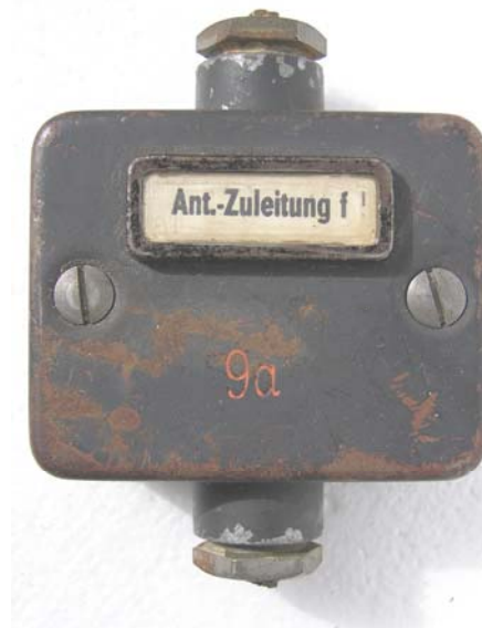
Abb. 6: Antennenzuleitung f mit Abschlußkasten Pz. Nr. 9a
