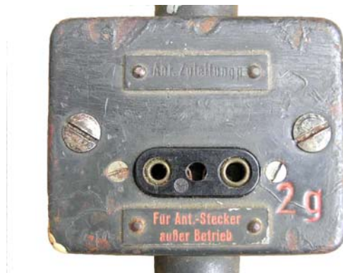
Abb. 20: Antennenzuleitung p; Kasten Pz. Nr. 2g
