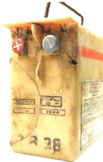
Abbildung 19 Kennzeichnung: Firmenbezeichnung „MARKO“ und Fertigungskennzeichen „oue“ Hersteller gemäß Tabelle 1 / 4/: Fa. Marschel&Co Fertigungskennzeichen gemäß Tabelle 3 / 4/: Accumulatorenwerke Fr. Müller A.G. Bielitz (O.S.); Nüßdorfer Str. 5
